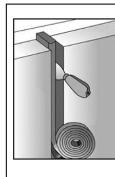
Nach der Expansion legt sich das Band fest an die Fugenflanken an. Unebenheiten werden durch die Elastizität des Fugendichtbandes ausgeglichen.
