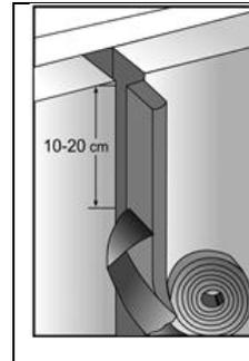
Dazu den Abdeckstreifen ca. 10-20 cm von der Selbstklebeseite des Bandes abziehen. Selbstklebeseite mit der Hand oder einem Spachtel gegen die Fugenflanke oder das Bauelement / Montageteil drücken, fixieren und dabei auf keinen Fall das Band in die Länge ziehen. Den Abdeckstreifen dann weiter von der Selbstklebeseite entsprechend dem Arbeitsfortschritt abziehen.
