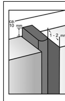
Beim Zuschneiden der Bänder sollte je lfm. etwa 1 cm zugegeben werde um Dehnungen auszugleichen. Bei breiteren Fugen ist das Band 1-2 mm von der Fugenkante zurückzusetzen.
