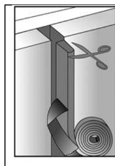
Nach dem Auspacken zunächst den Vorlaufstreifen von der Rolle abziehen, den Bandanfang besten mit einer Schere gerade abschneiden und unmittelbar danach verarbeiten.
