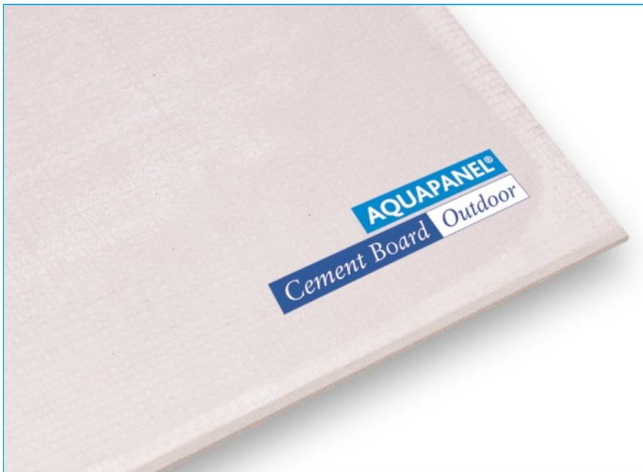
Die robuste, nichtbrennbare Bauplatte AQUAPANEL® Cement Board Outdoor ist die optimale Putzträgerplatte. Die Bauplatte besteht aus einem Kern aus Portlandzement und Zuschlagstoffen, die beidseitig mit einem Glasittergewebe armiert ist.
