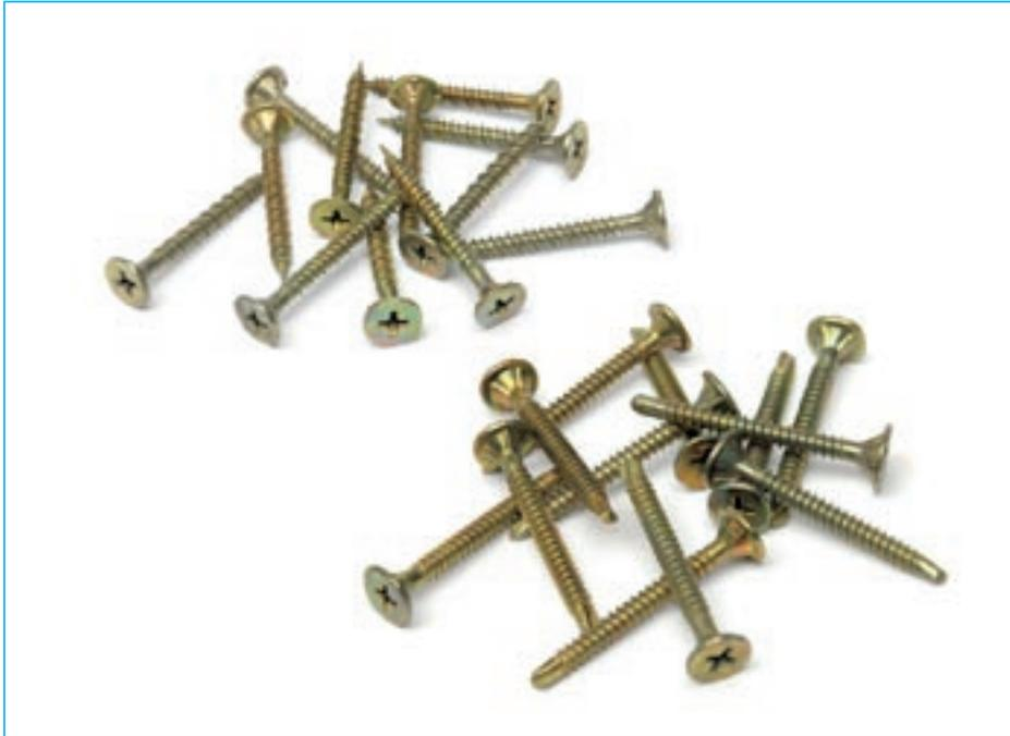
Die AQUAPANEL® Maxi Schrauben sind speziell für die Befestigung von AQUAPANEL® Cement Board auf Holz- und Metallunterkonstruktion mit unterschiedlichen Dicken entwickelt worden. Beide Versionen mit Nadelspitze und Bohrspitze besitzen einen Senkkopf. Die AQUAPANEL® Maxi Schrauben können für Wand und Decke im Innen- wie Außenbereich verwendet werden.
