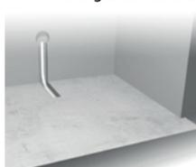
Der Boden, auf dem die Heizeinheit aufgebracht wird, muss eben, sicher, fest und ausreichend belastbar sein. Vor dem Verlegen der Heizmatte auf dem Estrich, muss der Untergrund sauber, trocken, fest, staub- und schmutzfrei sein. Sollte der Unterbau uneben sein, so ist dieser vor der Verlegung der Heizelemente zu nivellieren, sodass Hohlräume unterhalb der Heizleitung vermieden werden. Bewegungsfugen in der Unterkonstruktion dürfen auf keinen Fall mit dem Flächenheizelement überbrückt werden.
