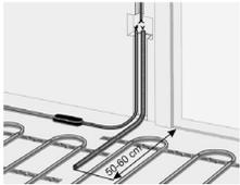
Die Fühlerleitung des Thermostats muss in einem separaten Leerrohr nach EN 61386-1 verlegt werden. Der Bodenfühler muss unmittelbar unter der Heizmatte positioniert werden, indem ein Schlitz im Boden aufgestemmt und das Leerrohr darin versenkt wird. Der Fühler sollte mittig zwischen zwei Heizleitern positioniert werden, also in der Mitte einer Heiz-
