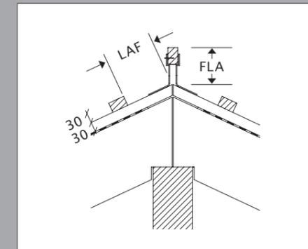
LAF = Lattenabstand zum Firstschnittpunkt (in mm)
