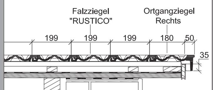
\* Laut dem Regelwerk des ZVDH soll bei Ortgangziegeln der Abstand zwischen Innenkante Ortganglappen und Außenkante Giebelwand bzw. Außenkante Bekleidung mindestens 1 cm betragen.
