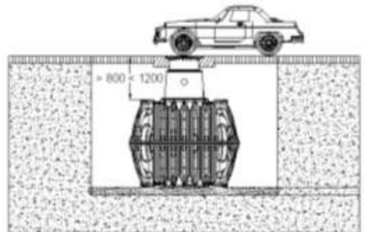
Überdeckungshöhen mit Teleskop Domschacht LKW (Abdeckung Klasse D – bauseits zu stellen) im LKW befahrenen Bereich (Belastung bis 12 to).
