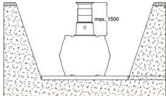
Überdeckungshöhen mit Teleskop Domschacht Guss (mit Gussabdeckung Klasse B) im PKW befahrenen Bereich (Belastung bis 3,5 t).
