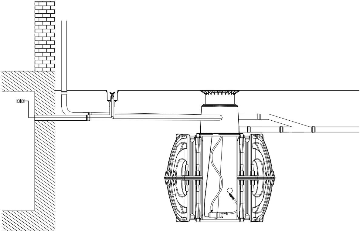
**Achtung:** Der Abstand zwischen Wasseranschlussbox und Erdtank ist durch die Länge des Druckschlauches begrenzt – Länge 10 m.
