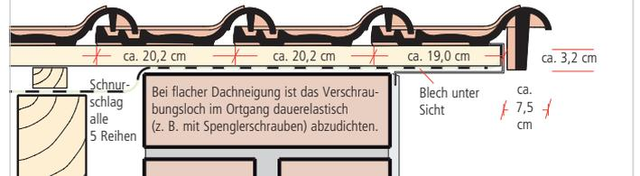
Maßangaben für Ausführung mit Firstanschlussziegeln und ohne First/Gratrolle. Angaben in mm.
