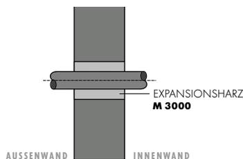
Zur Befestigung und dauerhaften Abdichtung gegen drückendes Wasser gemäß DIN 18195 Lastfall 6
