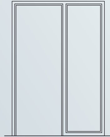
Stahlzarge mit feststehendem Seitenteil. Verglasung bauseits.
