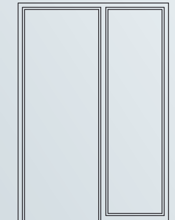
Stahlzarge mit feststehendem Seitenteil. Verglasung bauseits.
