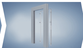
Vorderschale in die Öffnung schieben und ausrichten
