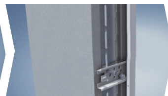
Alle Trapezanker mit Schrauben am UA-Profil befestigen. Nach Erfordernis unterfüttern
