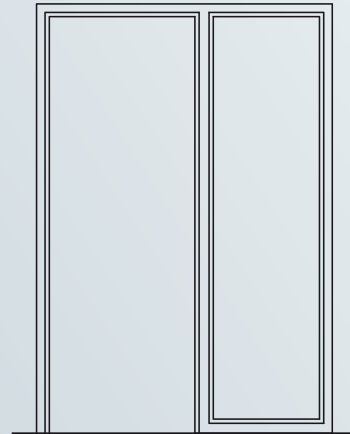
Stahlzarge mit feststehendem Seitenteil. Verglasung bauseits.
