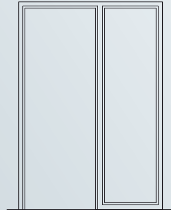
Stahlzarge mit feststehendem Seitenteil. Verglasung bauseits.
