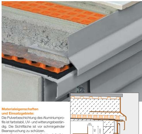
In der Estrichschicht, in die Schlüter®-BARA-RK eingebaut ist, darf sich kein Stauwasser ansammeln (Einbau einer Flächendrainage), da alkalisch stark angereichertes Wasser Aluminium angreift. In besonderen Anwendungsfällen ist je nach zu erwartender chemischer oder mechanischer Belastung die Verwendbarkeit von Schlüter®-BARA-RK zu klären.
