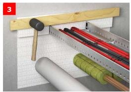
Einstreichen aller Schnittkanten bzw. Stöße der Mineralwolleplatten sowie der Kabeltragekonstruktion und Kabel innerhalb der Abschottung mit der Beschichtung. Vorsichtig die Mineralwolleplatten beidseitig einpassen. Hohlräume mit loser Mineralwolle (Schmelzpunkt > 1000 °C) fest ausstopfen (z.B. mit Hilfe eines Holzstabes).
