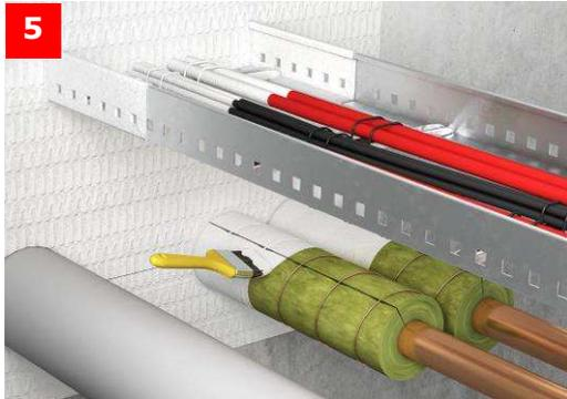
Beschichtung der Schottoberflächen im Randbereich einschließlich eines  $\geq 50$  mm breiten Randes angrenzender Bauteiloberflächen mit der Beschichtung, Trockenschichtdicke  $\geq 1$  mm. Der Einsatz eines umlaufenden Klebebandes für einen sauberen Abschluss wird hierbei empfohlen. Kabel und Kabeltragekonstruktionen beidseitig auf einer Länge von  $\geq 200$  mm (gemessen ab Schottoberfläche) mit der Beschichtung, Trockenschichtdicke  $\geq 1$  mm, beschichten.
