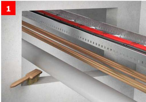
**1** Reinigung der Einbauöffnung. Ermittlung der Bauteilmaße und der Lage bzw. Abmessungen der abzuschottenden Installationen. (siehe Zulassung: ABZ Z-19.15-1870)
