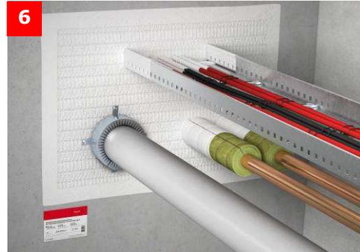
Beschriftung des Kennzeichnungsschildes durch den Verarbeiter (Angabe der Typenbezeichnung, Feuerwiderstandsklasse, Zulassung, Ausführender und Einbaudatum). Sichtbare, dauerhafte Befestigung in unmittelbarer Schottnähe. Jedes Schott ist einzeln zu kennzeichnen.
