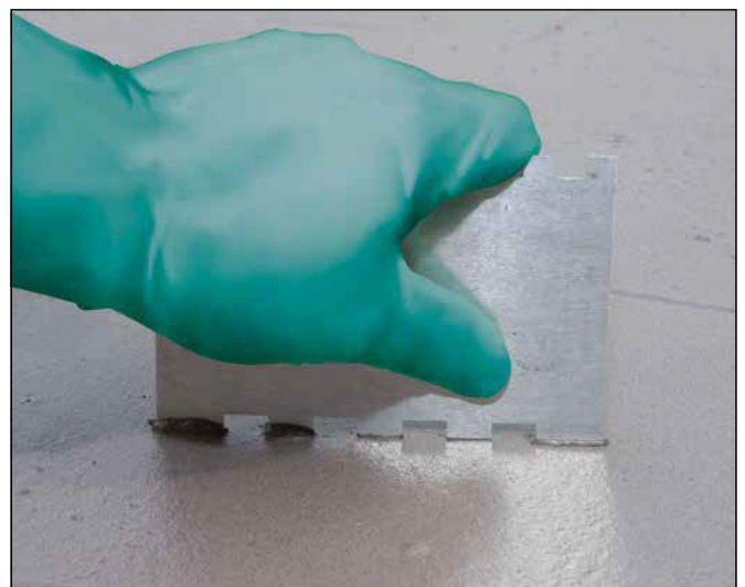
12 Messung der Nass-Schichtdicke von 1,3 mm mit einem Nass-Schicht-Dickenmesser.
