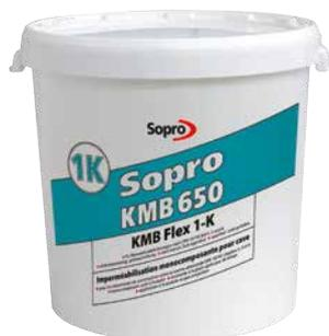
Einkomponentige, lösemittelfreie, polystyrolgefüllte, kunststoffmodifizierte Bitumen-Dickbeschichtung (PMBC) zur Herstellung von flexiblen, rissüberbrückenden Bauwerksabdichtungen gemäß DIN 18533 Teil 3 im Anwendungsbereich W1-E „Bodenfeuchte und nichtdrückendes Wasser“, W3-E „Nicht drückendes Wasser auf erdüber-schütteten Decken“ und W4-E „Spritzwasser und Bodenfeuchte am Wandsockel“ (ehemals DIN 18195 Teil 4 und 6).
