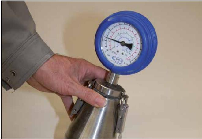
1 Bestimmung des Feuchtigkeitsgehaltes des Calciumsulfat-Estriches mit dem CM-Gerät. Maximaler Feuchtigkeitsgehalt  $\leq 0,5$  CM-% (unbeheizt) bzw.  $\leq 0,3$  CM-% (beheizt).
