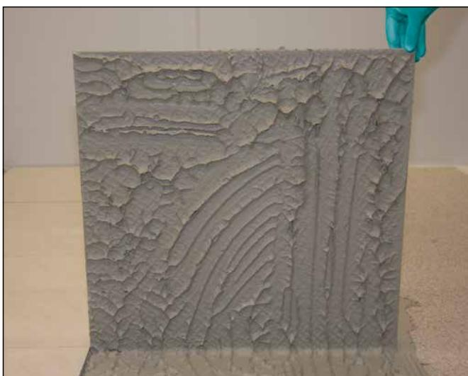
**5** Sopro VarioFlex® XL stellt eine optimale, nahezu hohlraumfreie Rückseitenbenetzung sicher.
