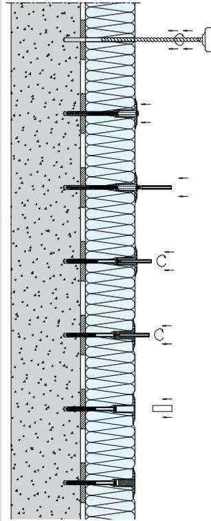
Oberflächenbündig gesetzte Schraubdübel Knauf STR U werden mit Knauf STR U Stopfen verschlossen.
