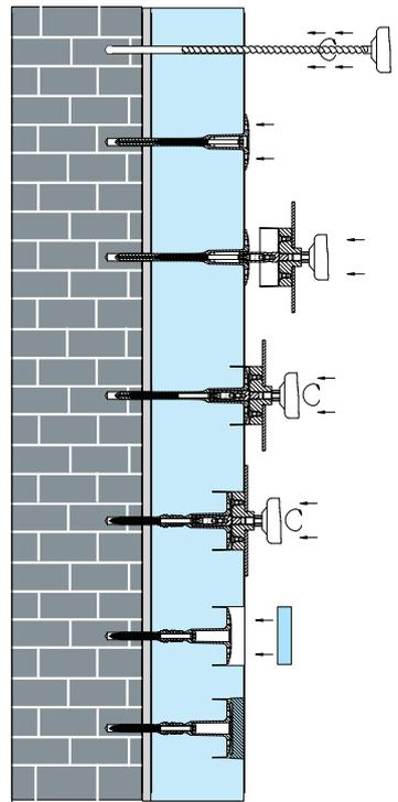
Bei der versenkten Montage werden die Aussparungen mit Knauf STR U Rondellen verschlossen.
