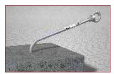
Im Gegensatz zu den starren, schweren Stützen verformt sich der schlanke ABS-Lock® III-BE. Er knickt flach um. Dabei nimmt das Edelstahl einen enormen Teil der Sturzbelastung auf. Mensch und Dach werden geschont und die Kräfte werden gehalten.
